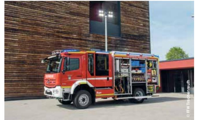
Die Entscheidung für ein Fahrgestell mit permanentem Allradantrieb wurde getroffen, um die Geländegängigkeit und Wendigkeit abseits der Straße, beispielsweise auf Feld- oder Waldwegen sowie schlechter erreichbarer Örtlichkeiten wie etwa Aussiedlerhöfe, zu verbessern. Dies ermöglicht der Feuerwehr Tirschenreuth schnell und effektiv im gesamten Einsatzgebiet eingreifen zu können.
