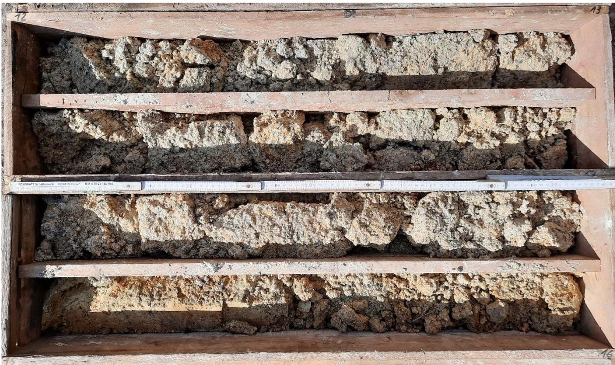
**Foto 4:** Bohrkerne Rohstofferkundungsbohrung ZP 4: 12 – 16 m
