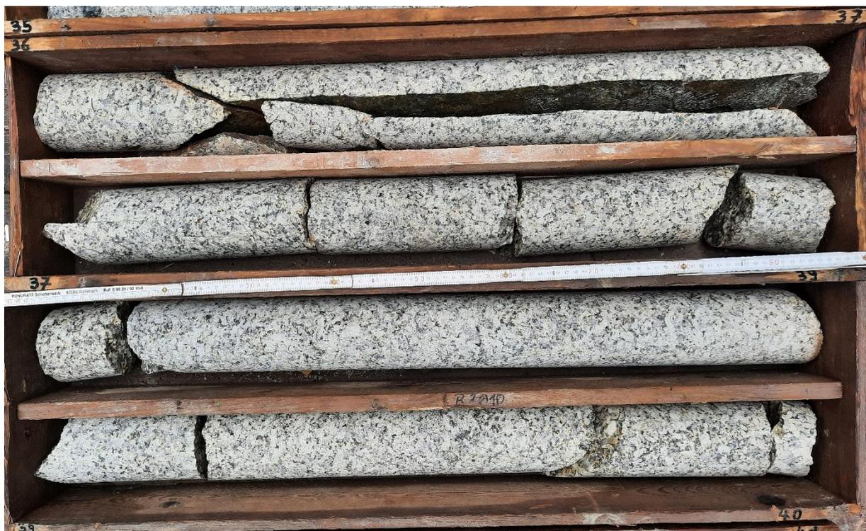
**Foto 10:** Bohrkern Rohstofferkundungsbohrung ZP 1: 36 – 40 m
