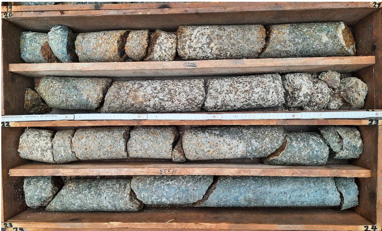
**Foto 6:** Bohrkerne Rohstofferkundungsbohrung ZP 1: 20 – 24 m
