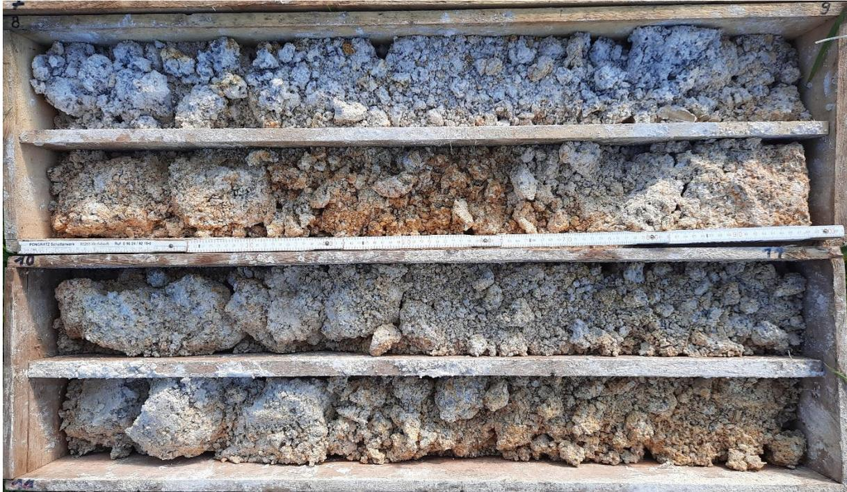
**Foto 3:** Bohrkern Rohstofferkundungsbohrung ZP 3: 8 – 12 m
