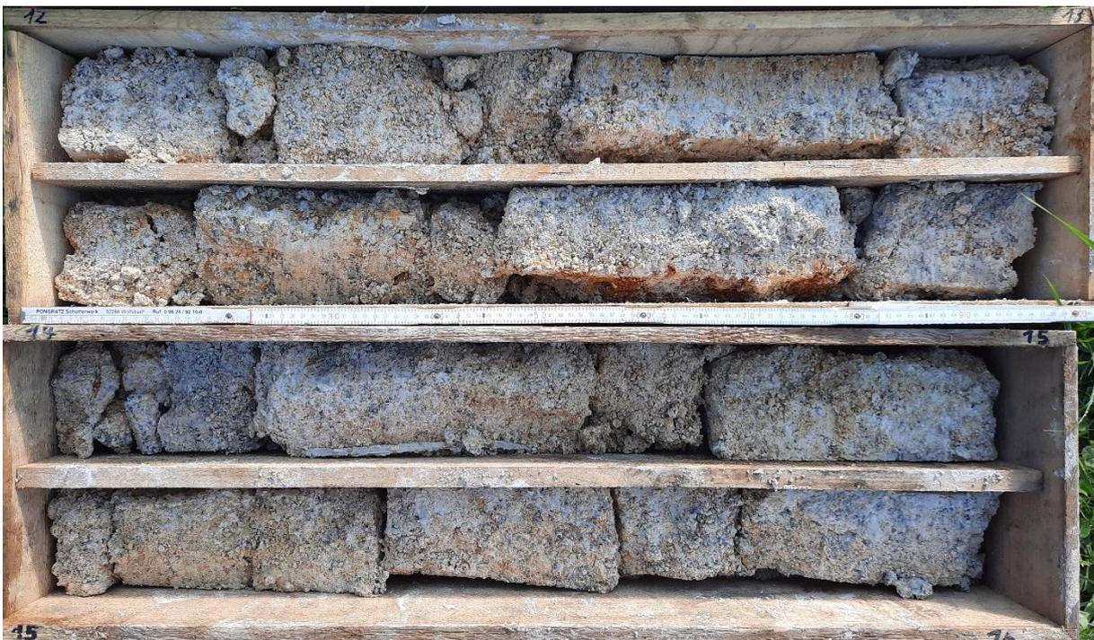
**Foto 4:** Bohrkern Rohstofferkundungsbohrung ZP 3: 12 – 16 m
