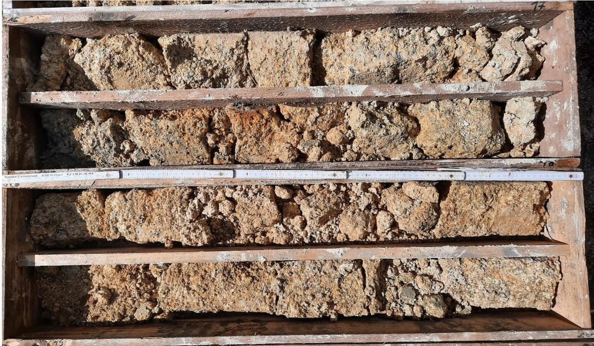
**Foto 5:** Bohrkerne Rohstofferkundungsbohrung ZP 2: 16 – 20 m
