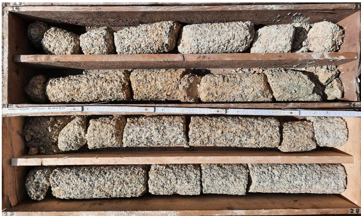
**Foto 7:** Bohrkerne Rohstofferkundungsbohrung ZP 2: 24 – 28 m
