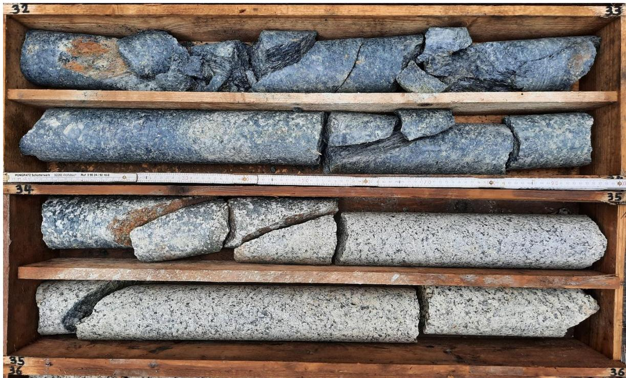
**Foto 9:** Bohrkern Rohstofferkundungsbohrung ZP 1: 32 – 36 m
