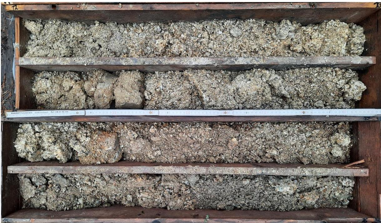
**Foto 4:** Bohrkerne Rohstofferkundungsbohrung ZP 1: 12 – 16 m
