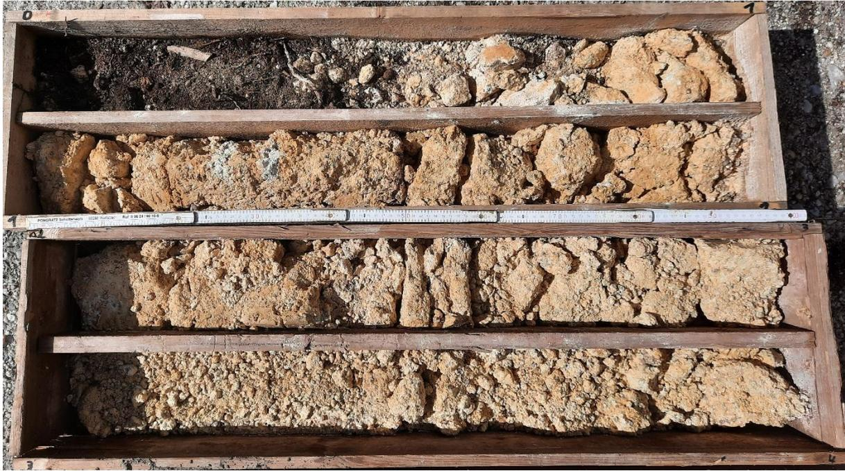
**Foto 1:** Bohrkern Rohstofferkundungsbohrung ZP 2: 0 – 4 m
