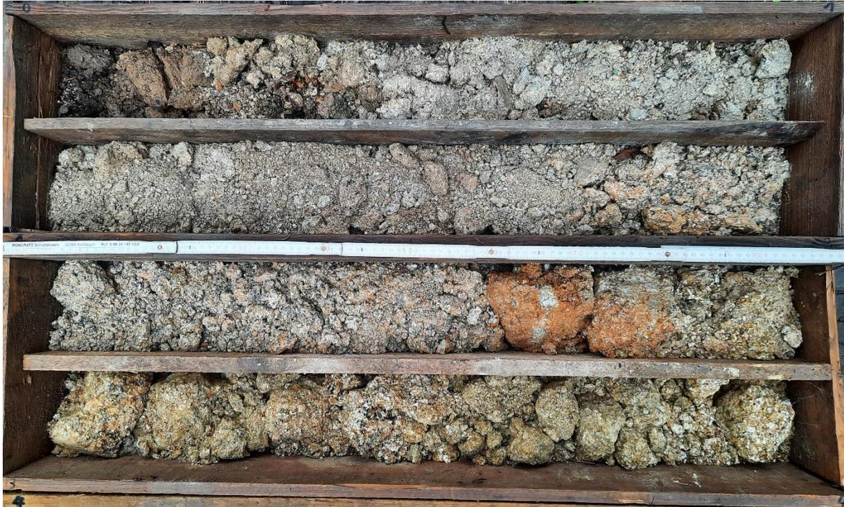
**Foto 1:** Bohrkern Rohstofferkundungsbohrung ZP 1: 0 – 4 m
