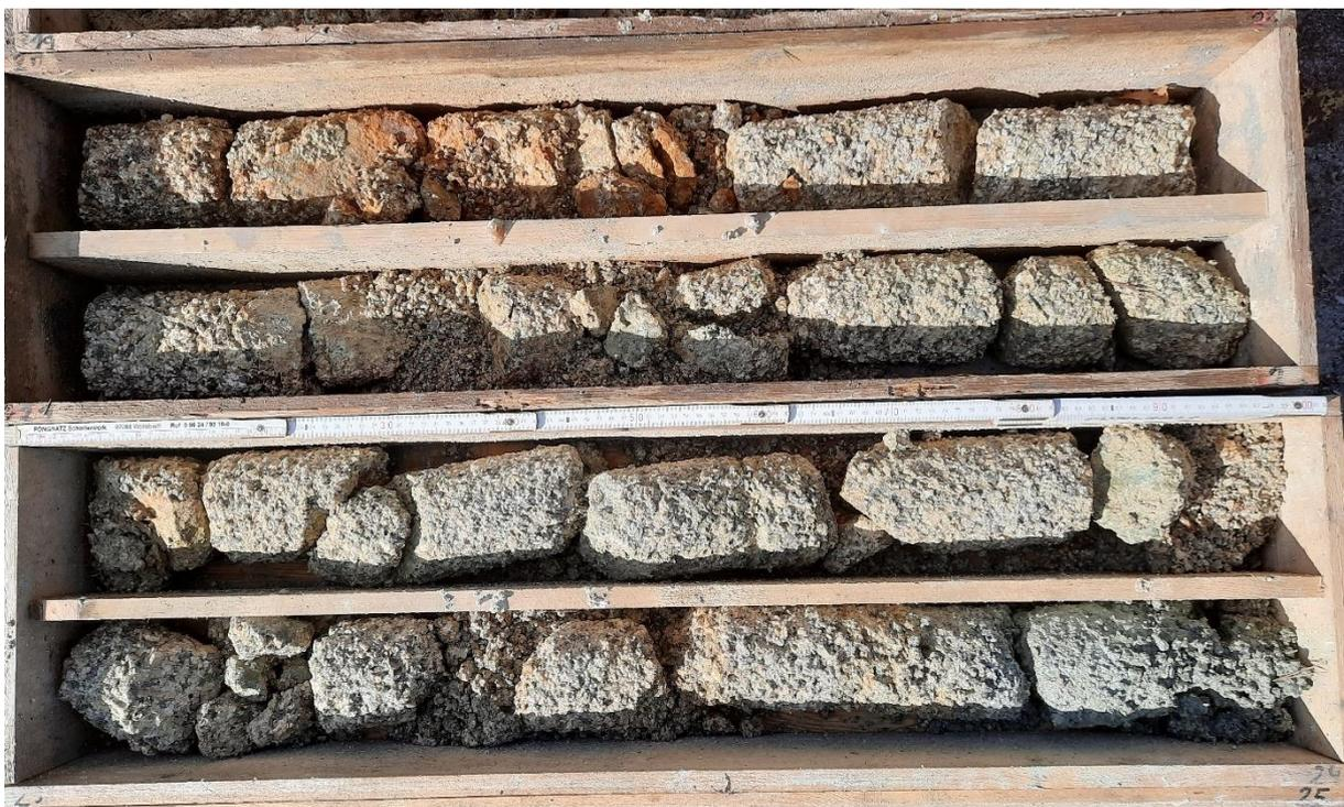
**Foto 6:** Bohrkerne Rohstofferkundungsbohrung ZP 4: 20 – 24 m
