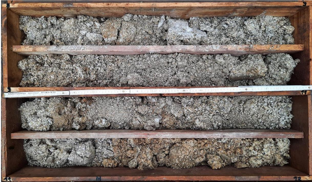
**Foto 3:** Bohrkerne Rohstofferkundungsbohrung ZP 1: 8 – 12 m
