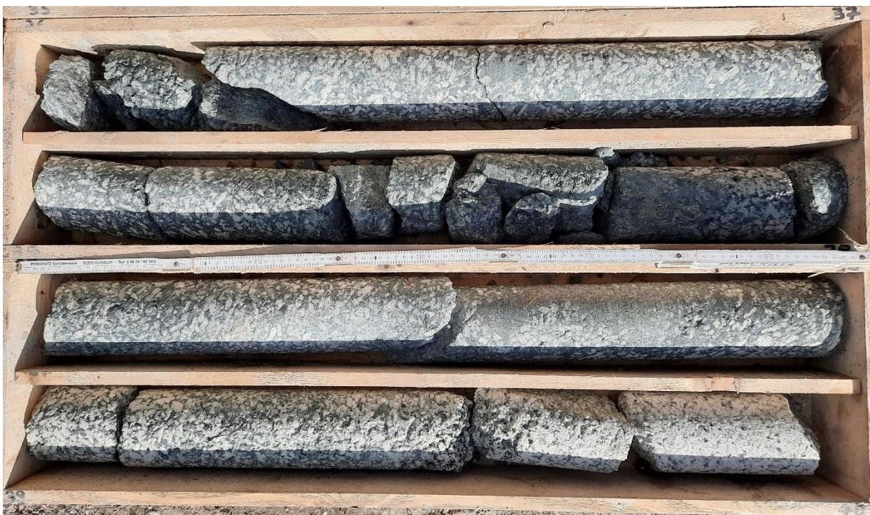
**Foto 10:** Bohrkerne Rohstofferkundungsbohrung ZP 4: 36 – 40 m
