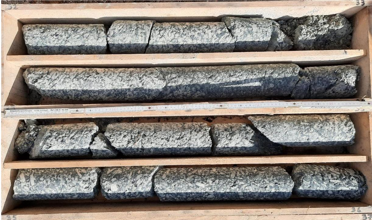
**Foto 9:** Bohrkerne Rohstofferkundungsbohrung ZP 4: 32 – 36 m
