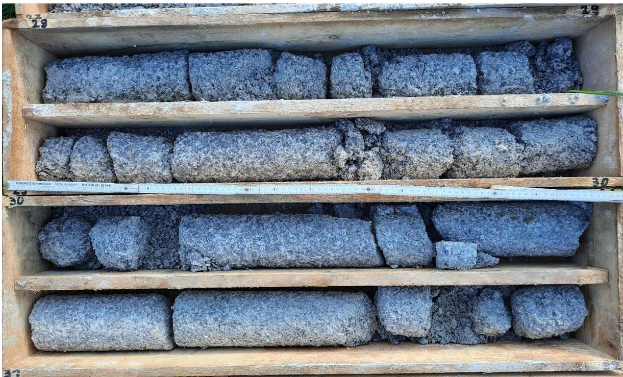
**Foto 8:** Bohrkerne Rohstofferkundungsbohrung ZP 3: 28 – 32 m
