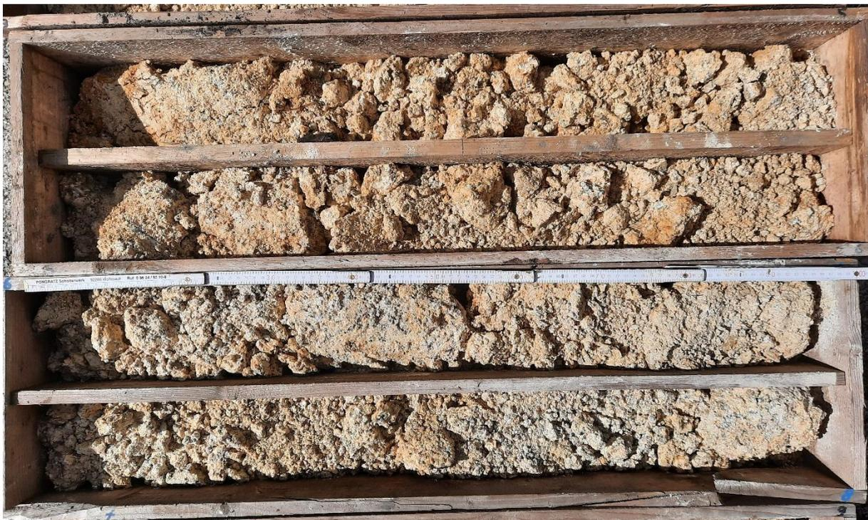
**Foto 2:** Bohrkern Rohstofferkundungsbohrung ZP 2: 4 – 8 m
