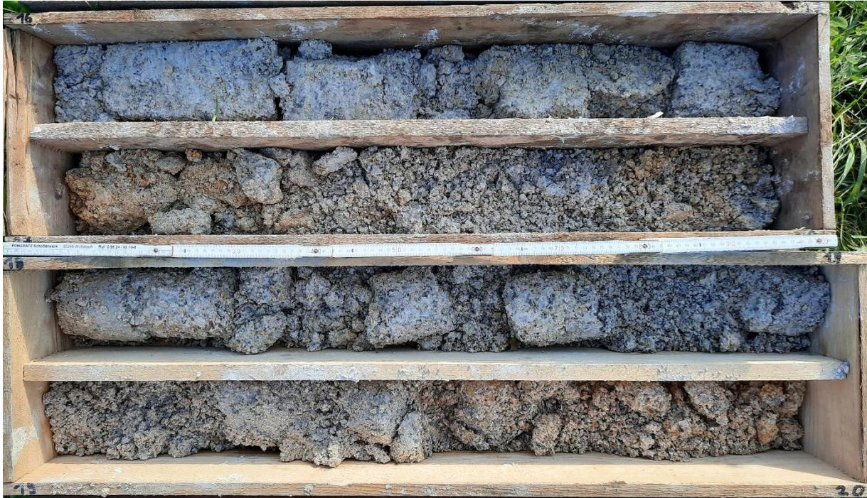
**Foto 5:** Bohrkern Rohstofferkundungsbohrung ZP 3: 16 – 20 m
