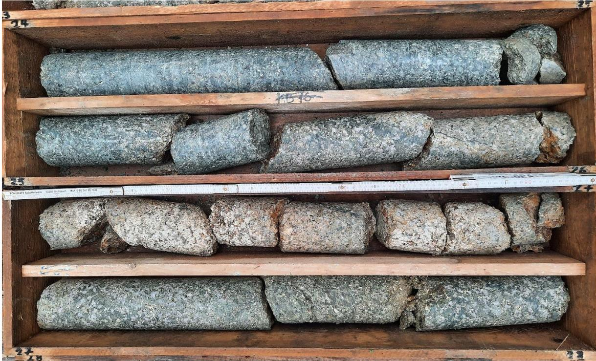
**Foto 7:** Bohrkern Rohstofferkundungsbohrung ZP 1: 24 – 28 m
