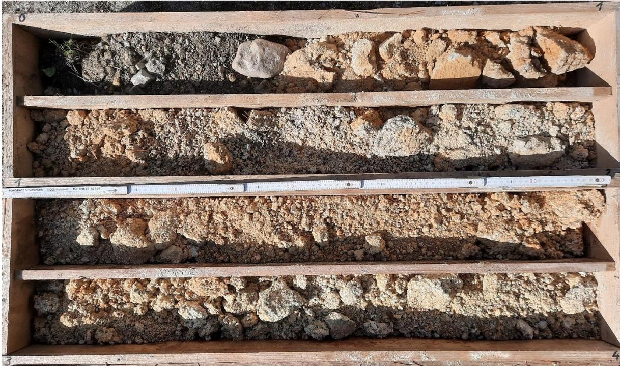
**Foto 1:** Bohrkerne Rohstofferkundungsbohrung ZP 4: 0 – 4 m
