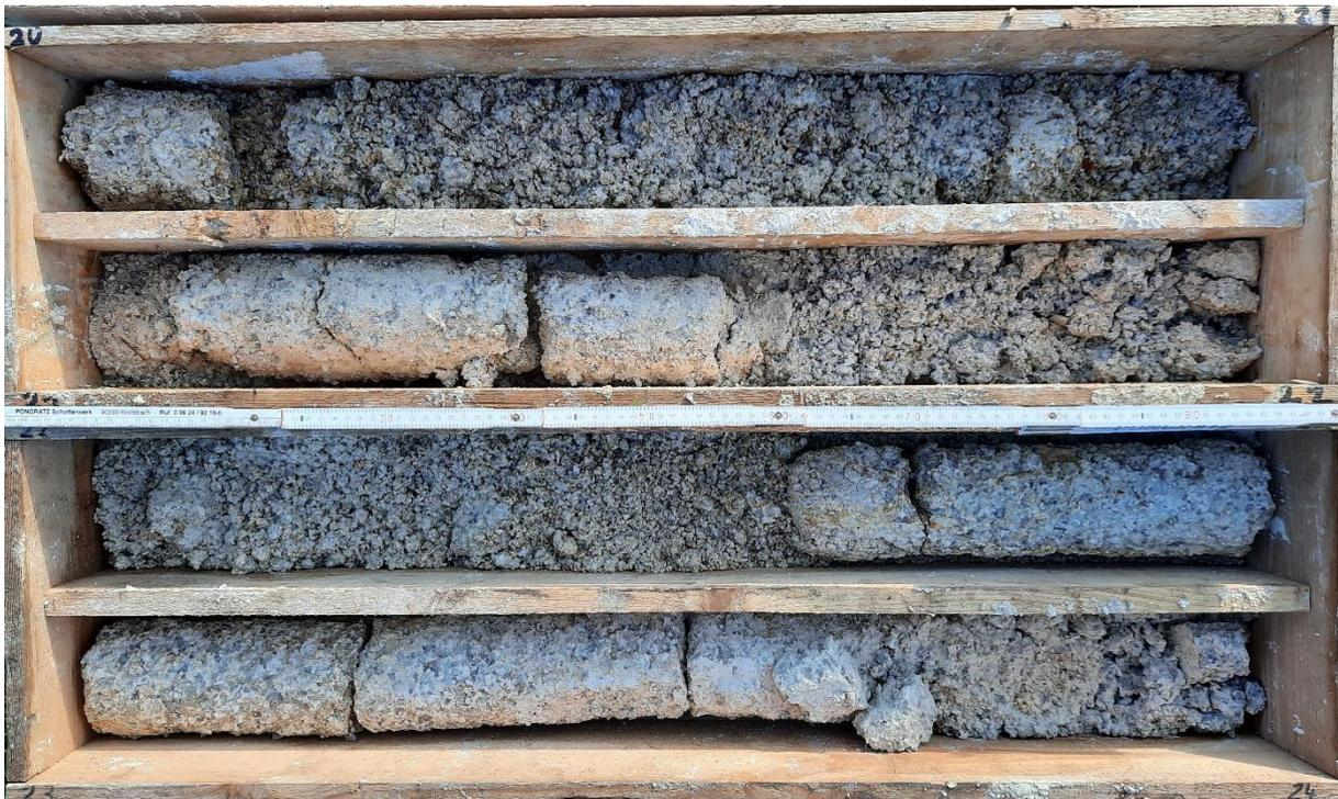
**Foto 6:** Bohrkern Rohstofferkundungsbohrung ZP 3: 20 – 24 m
