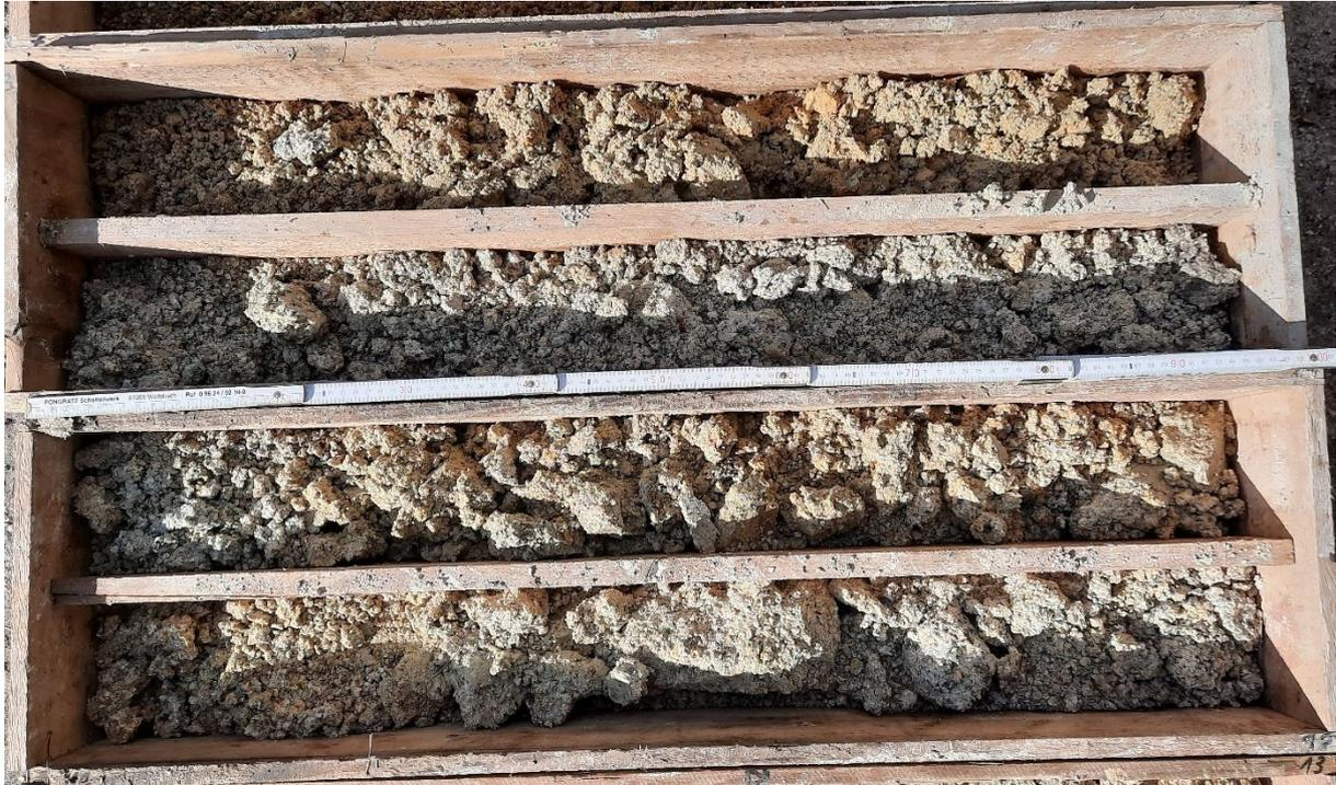
**Foto 3:** Bohrkerne Rohstofferkundungsbohrung ZP 4: 8 – 12 m
