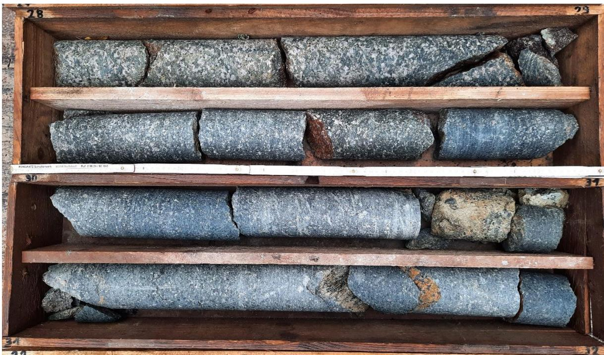
**Foto 8:** Bohrkern Rohstofferkundungsbohrung ZP 1: 28 – 32 m
