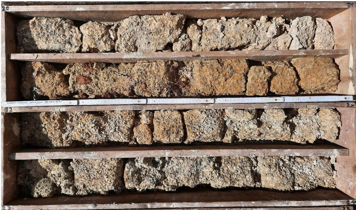
**Foto 6:** Bohrkerne Rohstofferkundungsbohrung ZP 2: 20 – 24 m
