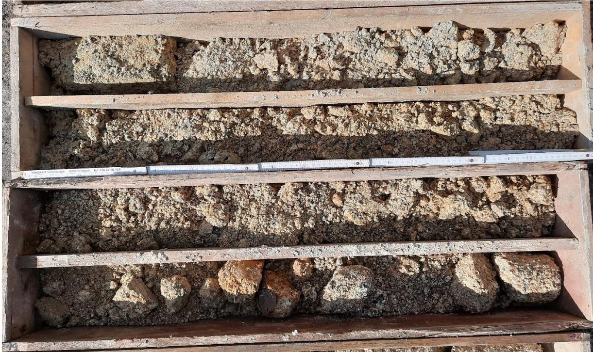
**Foto 5:** Bohrkerne Rohstofferkundungsbohrung ZP 4: 16 – 20 m
