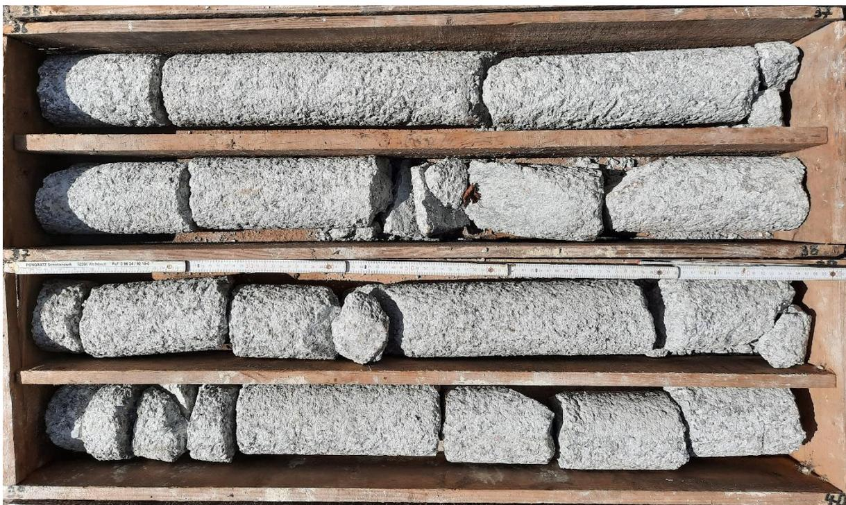
**Foto 10:** Bohrkerne Rohstofferkundungsbohrung ZP 2: 36 – 40 m
