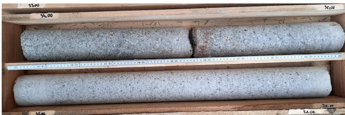
Foto 16: Bohrkerne Grundwassermessstelle GWM 7b: 34 – 36 m
