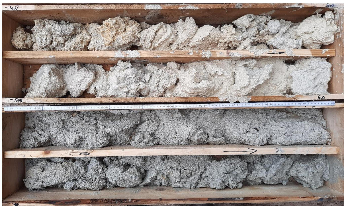
Foto 2: Bohrkern Grundwassermessstelle GWM 7b: 4 – 8 m
