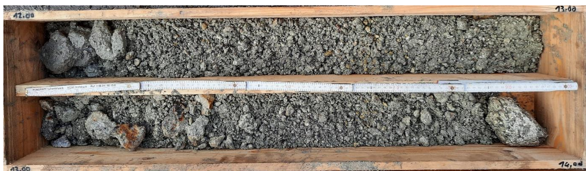
Foto 2: Bohrkern Grundwassermessstelle GWM 4b: 12 – 14 m
