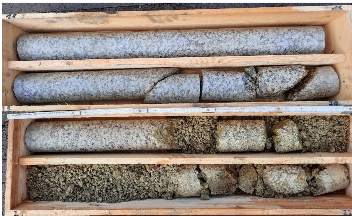
Foto 4: Bohrkerne Grundwassermessstelle GWM 4b: 18 – 22 m
