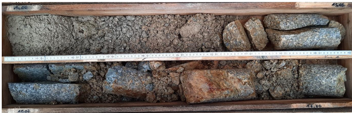
Foto 6: Bohrkerne Grundwassermessstelle GWM 7b: 14 – 16 m
