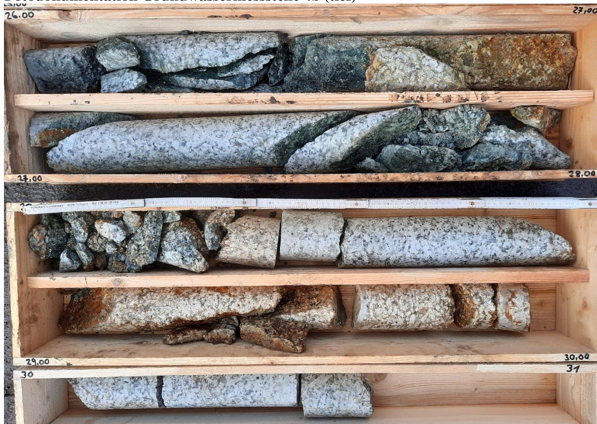
Foto 6: Bohrkern Grundwassermessstelle GWM 4b: 26 – 31 m
