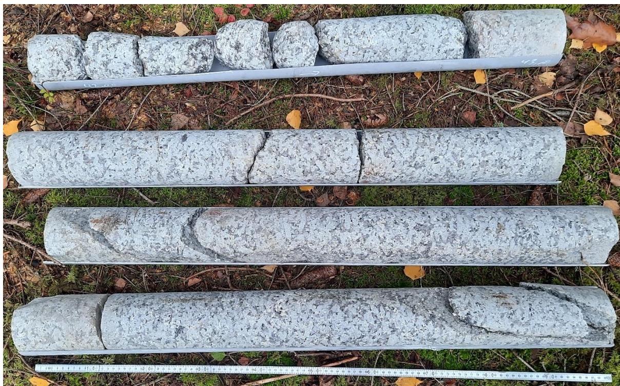
Foto 19: Bohrkerne Grundwassermessstelle GWM 7b: 32 – 46 m
