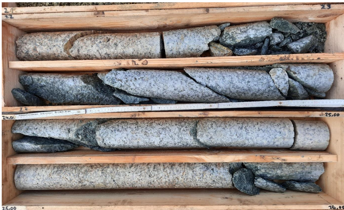
Foto 5: Bohrkerne Grundwassermessstelle GWM 4b: 22 – 26 m
