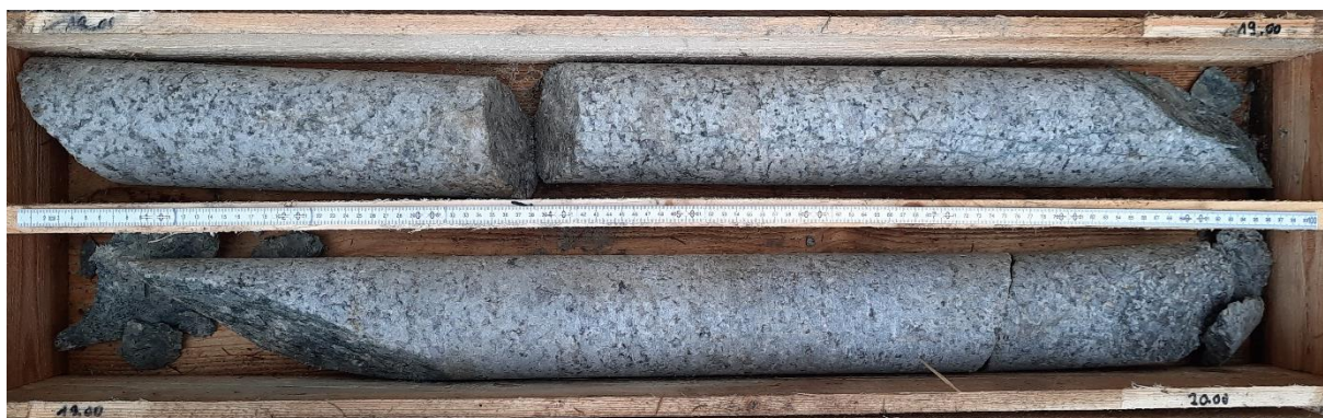
Foto 8: Bohrkerne Grundwassermessstelle GWM 7b: 18 – 20 m
