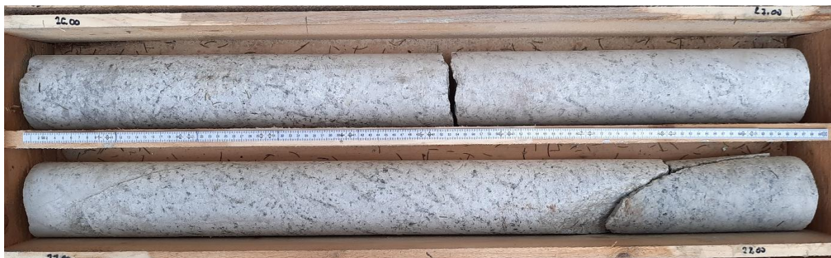
Foto 12: Bohrkerne Grundwassermessstelle GWM 7b: 26 – 28 m
