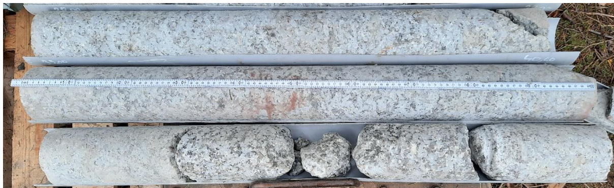
Foto 18: Bohrkerne Grundwassermessstelle GWM 7b: 39 – 42 m
