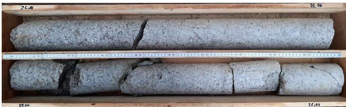
Foto 11: Bohrkern Grundwassermessstelle GWM 7b: 24 – 26 m
