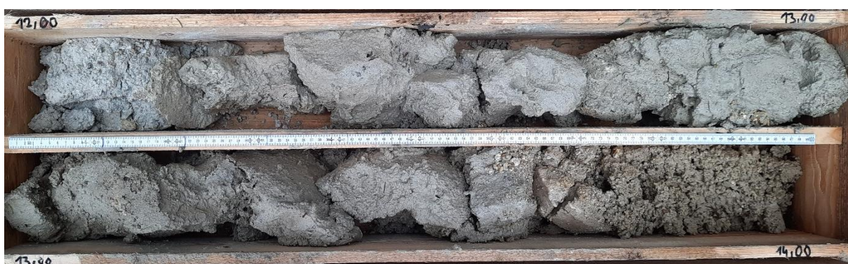
Foto 5: Bohrkern Grundwassermessstelle GWM 7b: 12 – 14 m
