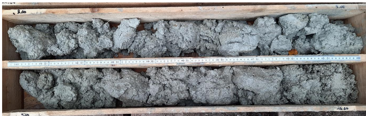
Foto 3: Bohrkern Grundwassermessstelle GWM 7b: 8 – 10 m
