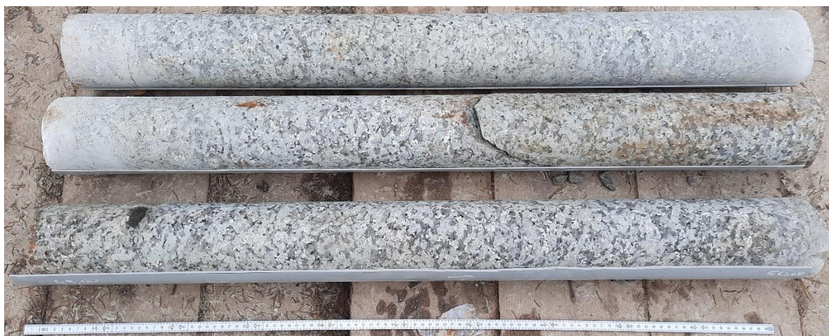
Foto 21: Bohrkern Grundwassermessstelle GWM 7b: 47 – 50 m (E.T.)
