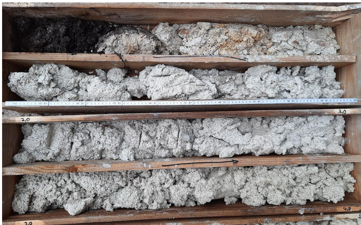
Foto 1: Bohrkern Grundwassermessstelle GWM 7b: 0 – 4 m
