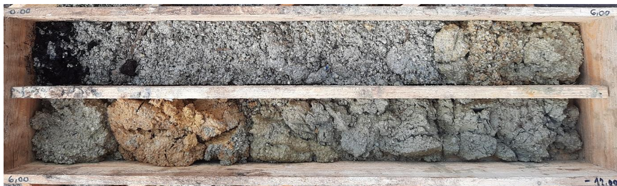
Foto 1: Bohrkern Grundwassermessstelle GWM 4b: 0 – 12 m
