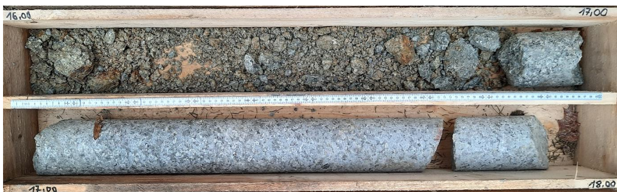
Foto 7: Bohrkerne Grundwassermessstelle GWM 7b: 16 – 18 m
