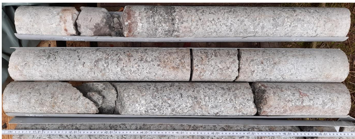
Foto 17: Bohrkerne Grundwassermessstelle GWM 7b: 36 – 39 m
