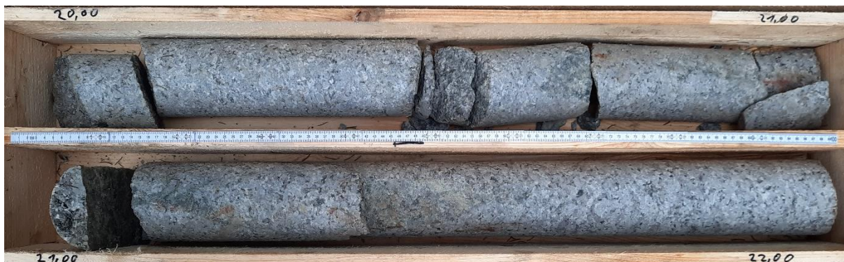
Foto 9: Bohrkern Grundwassermessstelle GWM 7b: 20 – 22 m
