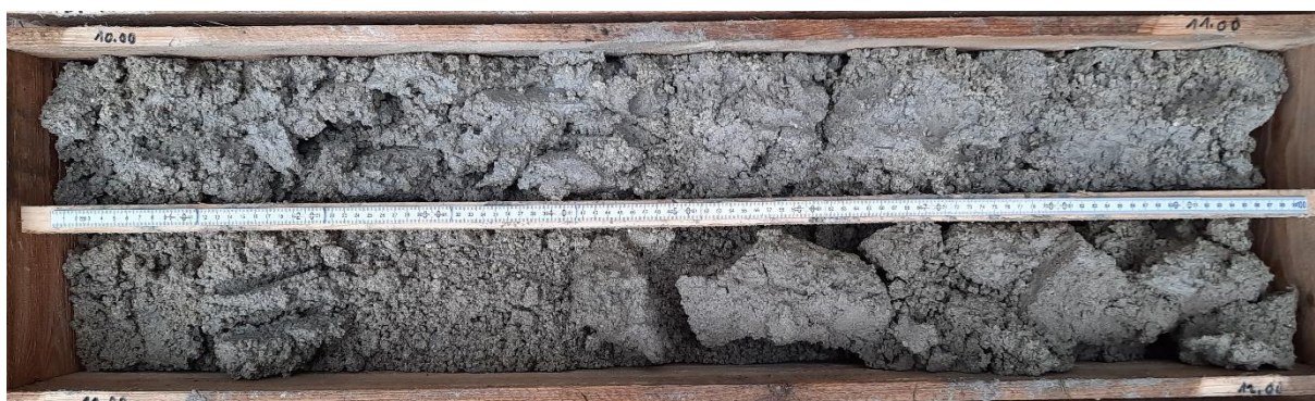
Foto 4: Bohrkern Grundwassermessstelle GWM 7b: 10 – 12 m
