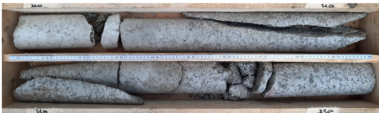
Foto 14: Bohrkerne Grundwassermessstelle GWM 7b: 30 – 32 m
