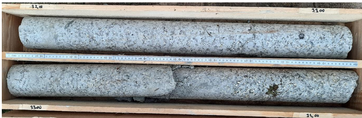
Foto 15: Bohrkerne Grundwassermessstelle GWM 7b: 32 – 34 m
